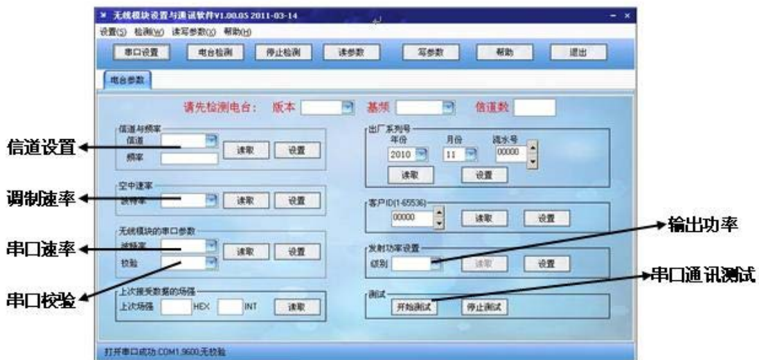
图六：BM100B 模块检测和参数配置软件
